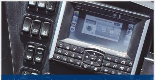
Cabina del conductor.- Consola elaborada en fibra de vidrio con tablero de control ergonómico para fácil manipulación del conductor. Asiento con regulación mecánica.
