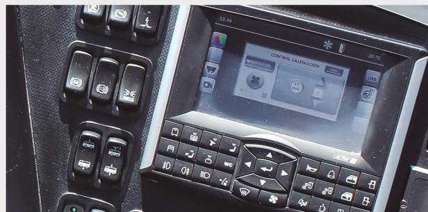
**Cabina del conductor.-** Consola elaborada en fibra de vidrio con tablero de control ergonómico para fácil manipulación del conductor. Asiento con regulación mecánica.
