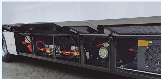
**Sistema eléctrico.-** Equipado con baterías de Litio-Ferrosulfato con una capacidad de 200 kWh con una autonomía de 150 a 180 km por carga. Puerto de carga rápida de hasta 60kW.
