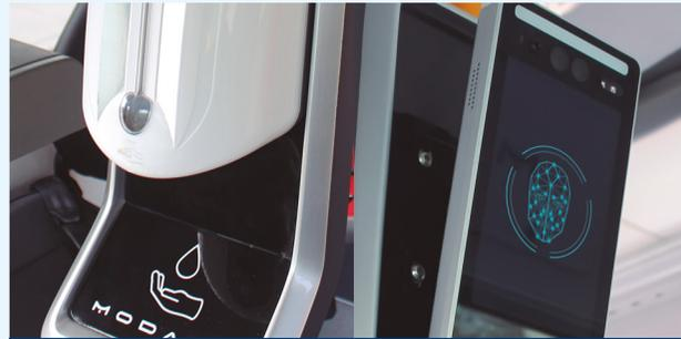
**Sistema de Bioseguridad.-** Consiste en purificador de aire, protección para el conductor, sensor de temperatura con detector facial de uso de mascarilla y dispensador automático de gel antibacterial.
